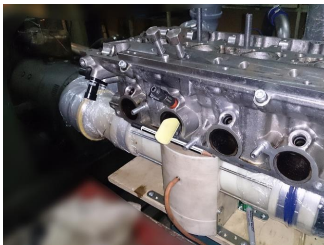
Рисунок 2.4– Внешний вид ГБЦ ВАЗ-21126 с установленной на нее заслонкой
