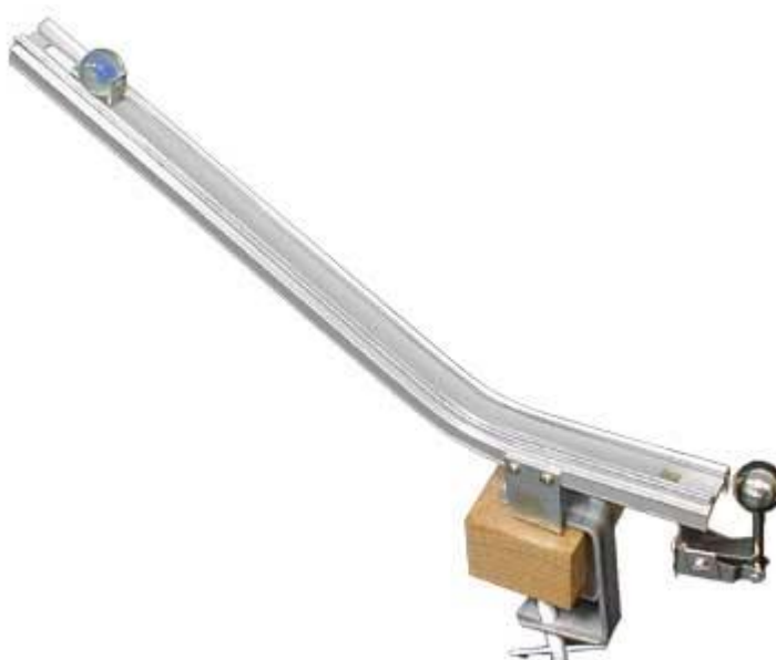
Рисунок 1.1 – Стенд для изучения движения тела, брошенного горизонтально.
