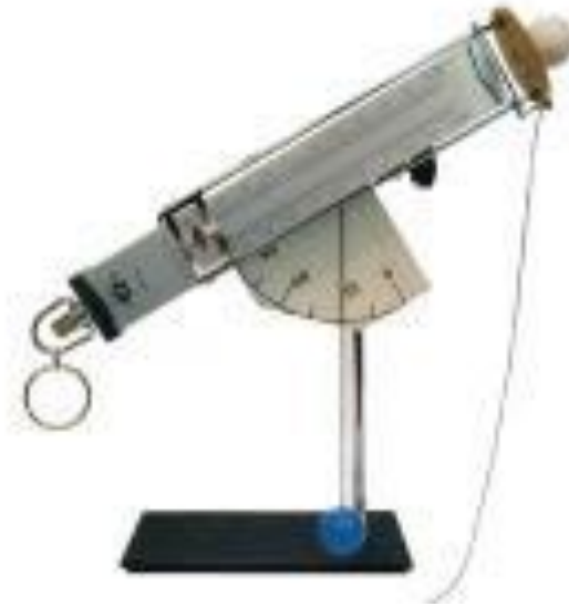
Рисунок 1.2 – Стенд для изучения движения тела, брошенного под углом к горизонту.
