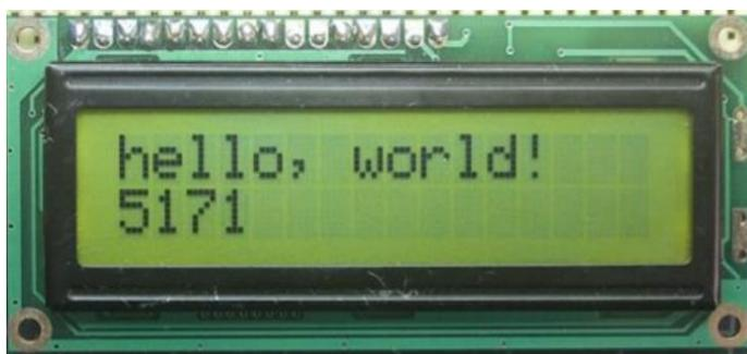
Рисунок 2.15 – LCD дисплей
