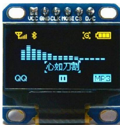
Рисунок 2.14 – OLED дисплей
