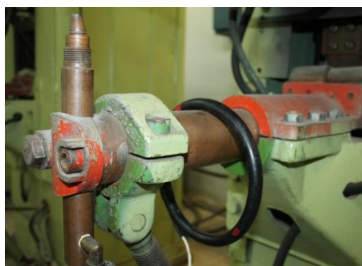
Рисунок 24 – Установка пояса Роговского на хоботе во вторичном контуре контактной сварочной машины
