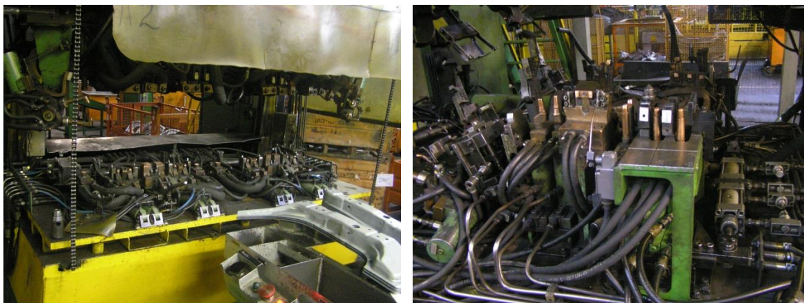
Рисунок 33 – Примеры вторичных контуров многоэлектродных сварочных машин, на которых затруднена установка датчиков тока
