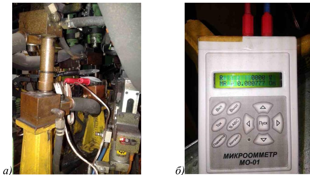
Рисунок 42 – Измерение омического сопротивления вторичного контура на многоэлектродной машине МСМ 503.651.421: установка измерительных щупов на сварочных электродах (а) и снятие показаний прибора (б)
