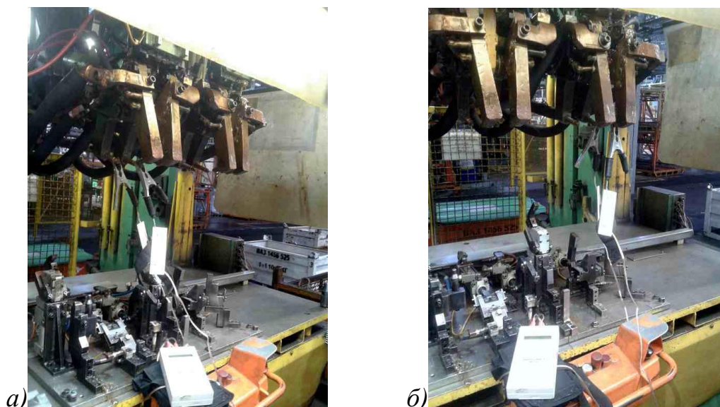
Рисунок 43 – Измерение омического сопротивления вторичного контура на многоэлектродной машине МСМ 503.618.421: установка измерительных щупов на сварочных электродах вторых клещей (а), установка измерительных щупов на сварочных электродах четвертых клещей (б)
