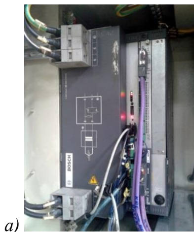
Рисунок 36 - Модуль управления сваркой PST 6000 (a) и алгоритм компенсации износа электродов (б)
