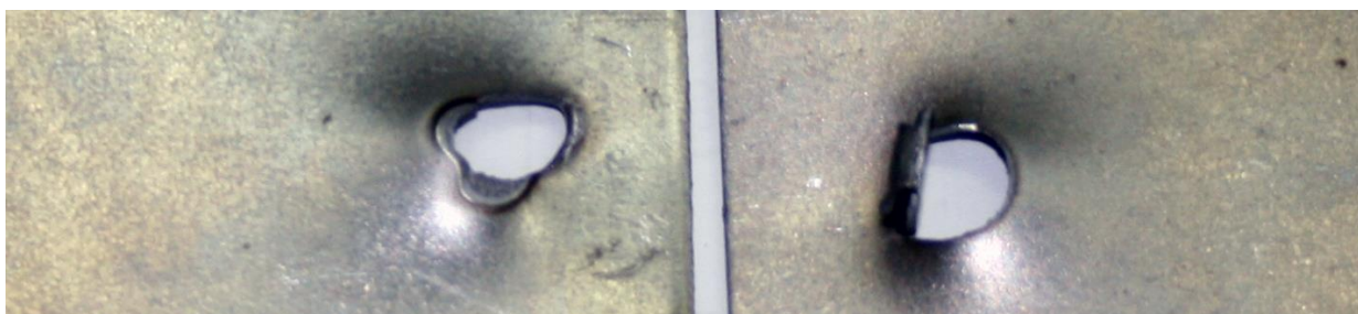
Рисунок 9 – Вырыв литой зоны на примере одного из испытанных образцов контактной точечной сварки
