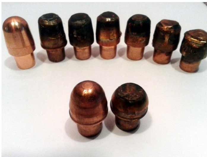
Рисунок 27 – Износ сварочных электродов в течение рабочей смены при интенсивной сварке на многоэлектродных сварочных машинах
