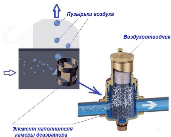
Рисунок 2 – Принцип работы воздухоотводчика
