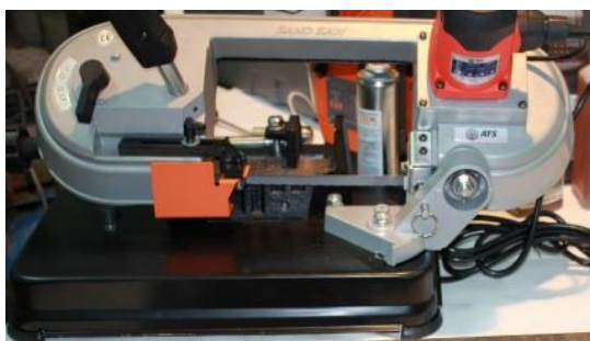
Рисунок 9 – Оборудование для резки прямоугольной трубы: малоразмерная ленточнопильная машина LS-100
