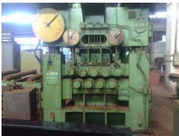
Рисунок 8 – Оборудование для правки прямоугольной трубы: малоразмерная правильная машина СКМЗ
