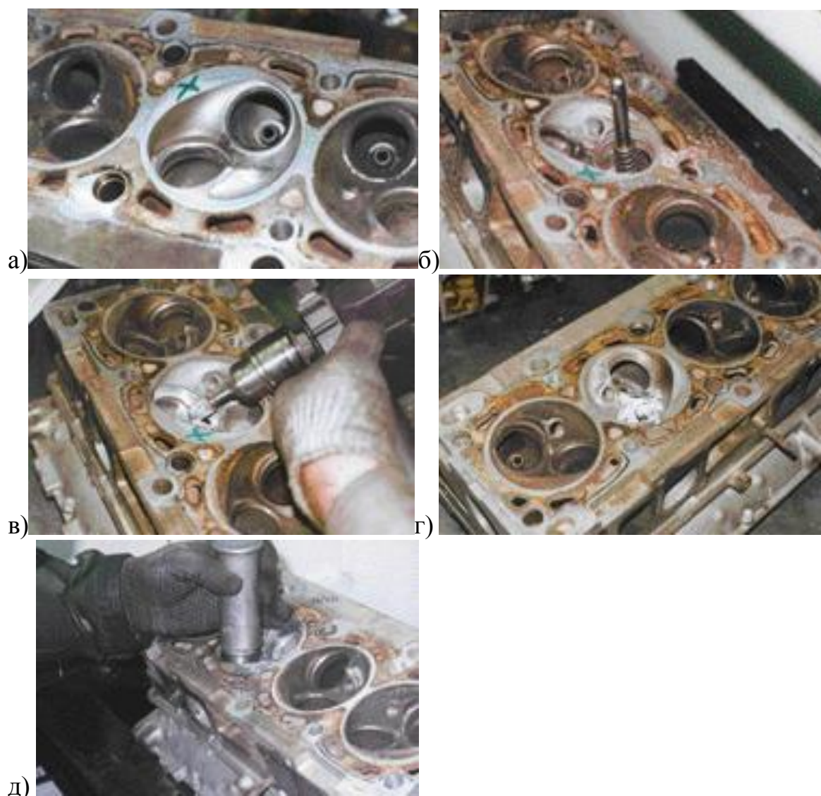
Рисунок 4 – Операции восстановления головки блока цилиндров: внешний осмотр и поиск дефектов (а), растачивание сёдел (б), разделка трещины (в), заварка трещины (г), запрессовка сёдел (д)
