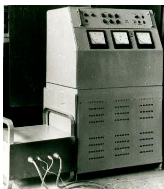
Рисунок 8 – Источник питания для трёхфазной сварки алюминиевых деталей
