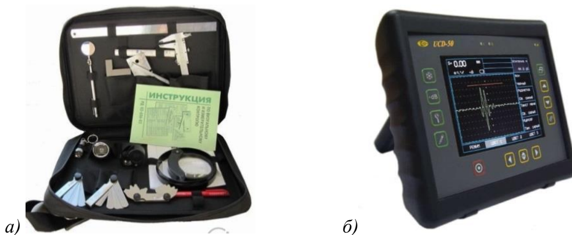
Рисунок 4 – Оборудование для проведения визуально-измерительного контроля (а) и ультразвукового контроля (б) сварных швов
