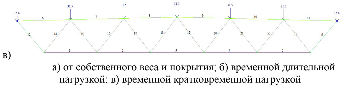
Рисунок 5 – Схемы загрузений фермы
