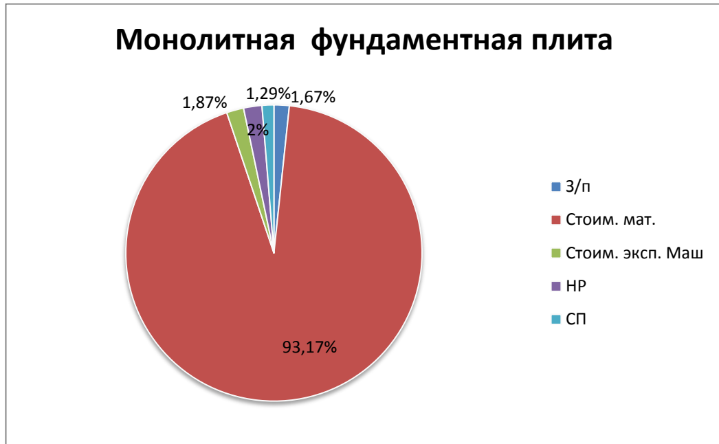
Рисунок 15 – Структура стоимости СМР по устройству фундаментной плиты
