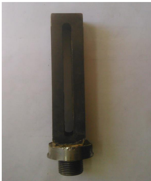
Рисунок 1. 25 - Пакет пластин после пайки
