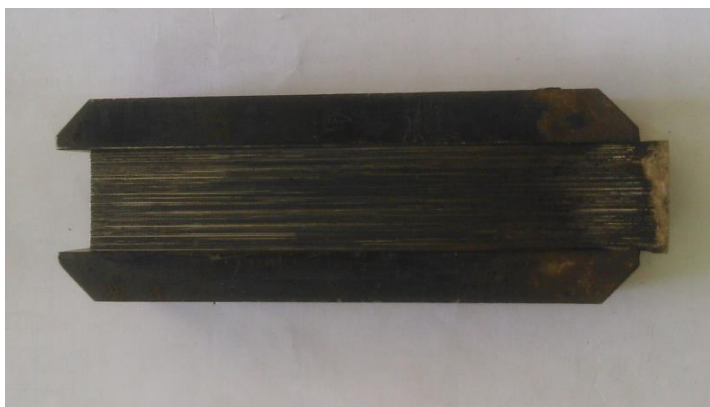
Рисунок 1. 23 - Пакет пластин после рекристаллизационного отжига
