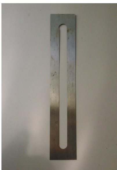
Рисунок 1.22 - Пластина сплава 49К2ФА, изготовленная при помощи электроэрозионной резки
