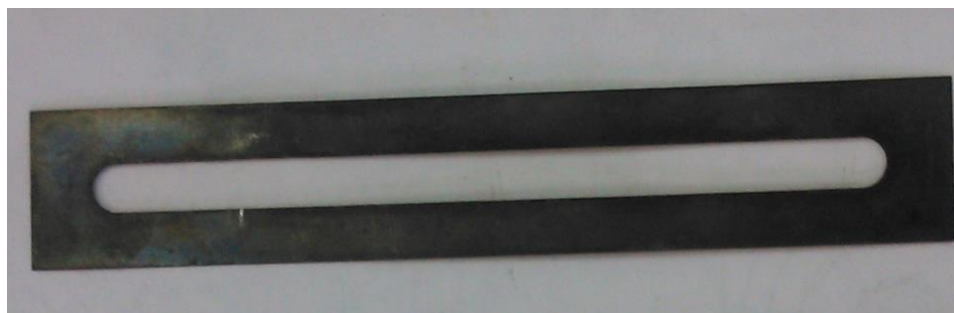
Рисунок 2.1 – Общий вид пластины магнитострикционного преобразователя.
