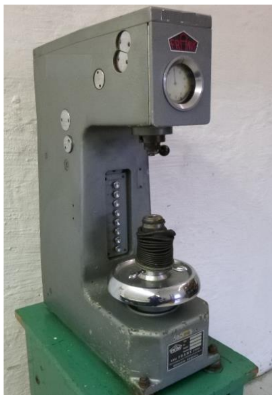
Рисунок 2.3 - Микротвердометр фирмы Karl Frank 75.
