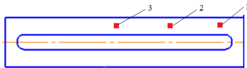
Рисунок 3.1 - Схематическое изображение пластины образца с указанием зон нагружения при испытаниях на твердость. Зона нагрузки отмечена красным квадратом.
