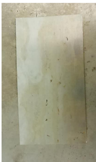
Рисунок 1. 20 - Часть листа из магнитострикционного сплава
