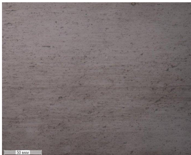
Рисунок 3.3 – Микроструктура сплава 49К2ФА после электроэрозионной резки (состояние поставки)
