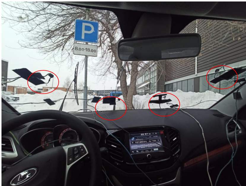
Рисунок 3.2-Установка термопар на внутреннюю поверхность
