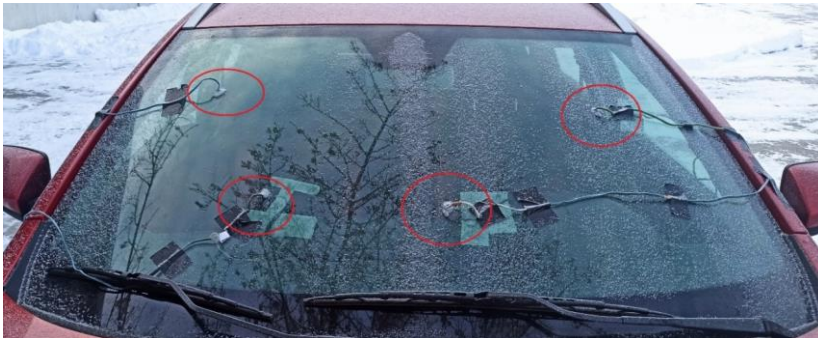
Рисунок 3.1-Установка термопар снаружи
