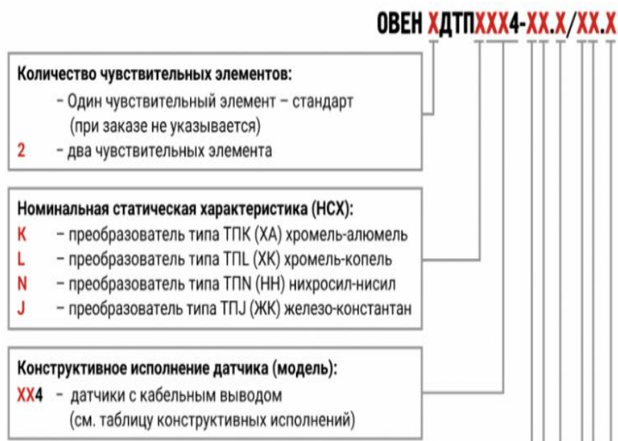
Рисунок 3.7 Описание и ТТХ термопар
