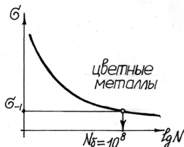
Рисунок 1.7 – Предел усталости для цветных металлов
