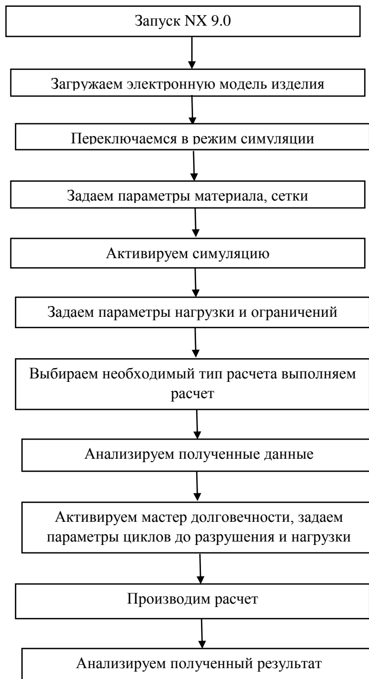
Рисунок 4.1 – Блок схема алгоритма расчета
