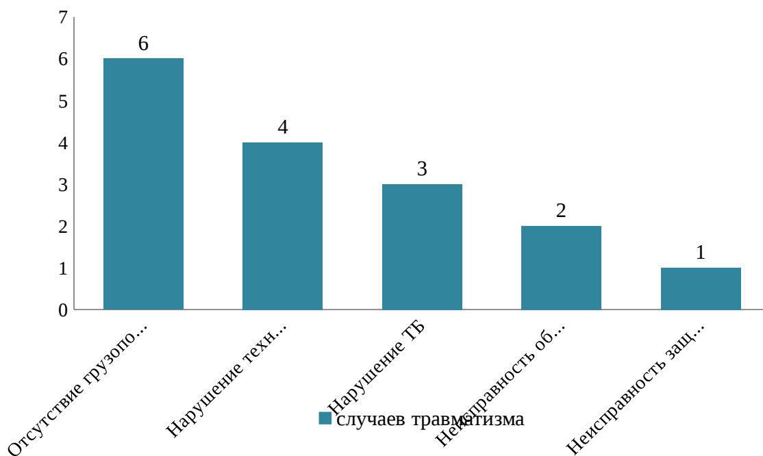
Рисунок 6 – Показатели количества случаев травматизма в зависимости от причин получения травм при осуществлении технического обслуживания и ремонта транспортных средств предприятия
