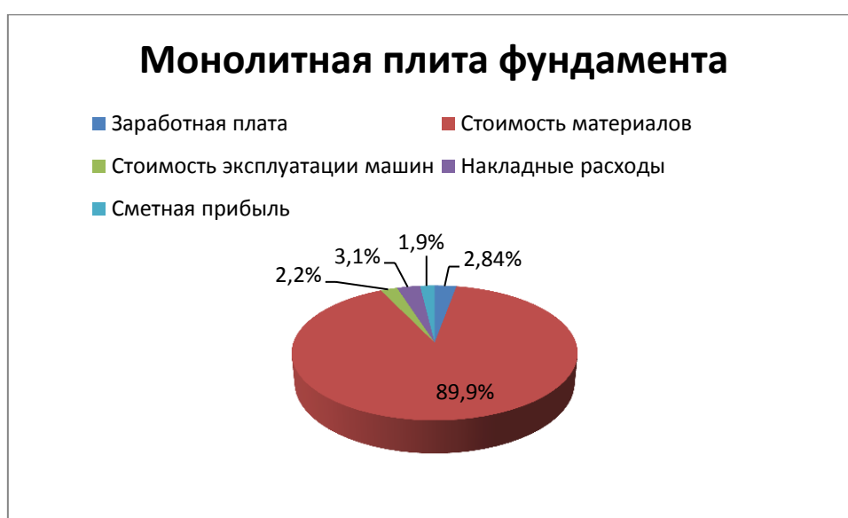
Рисунок 10 – Структура стоимости СМР по устройству плиты фундамента
