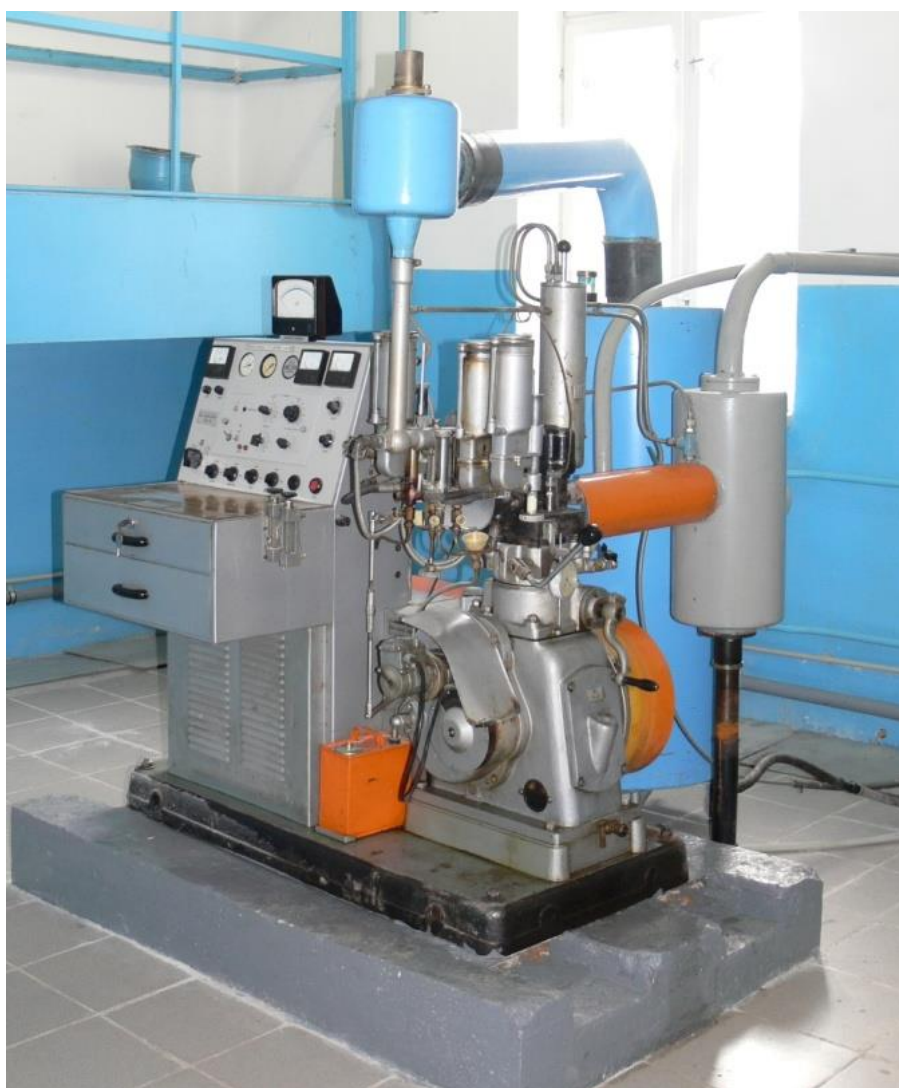
Рисунок 22 – Внешний вид установки УИТ-85
