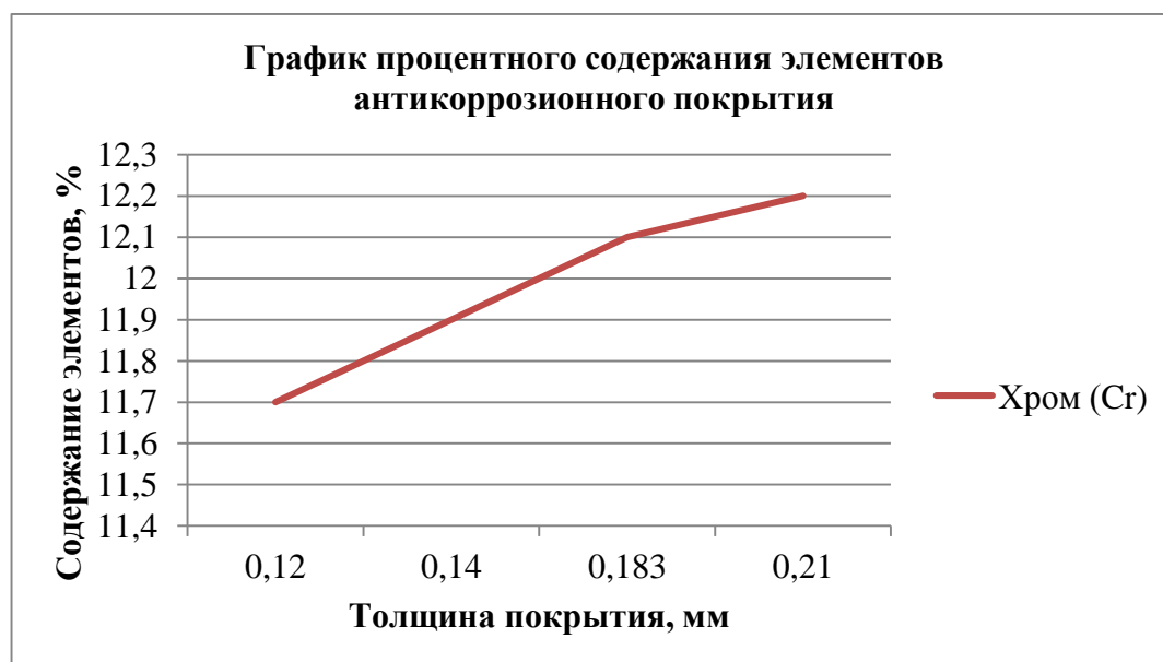
Рисунок 39 - Распределение химических элементов в антикоррозионном покрытии образца №1 и №2
