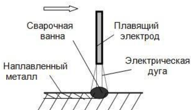
Рисунок 7 - Принцип наплавки в среде защитных газов. [17]
