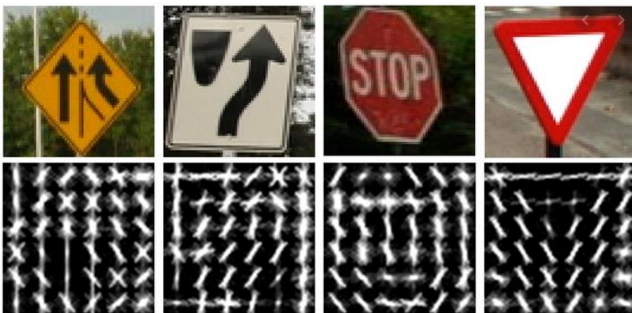
Рисунок 1– Пример преобразования изображений в признаки HOG [20]
