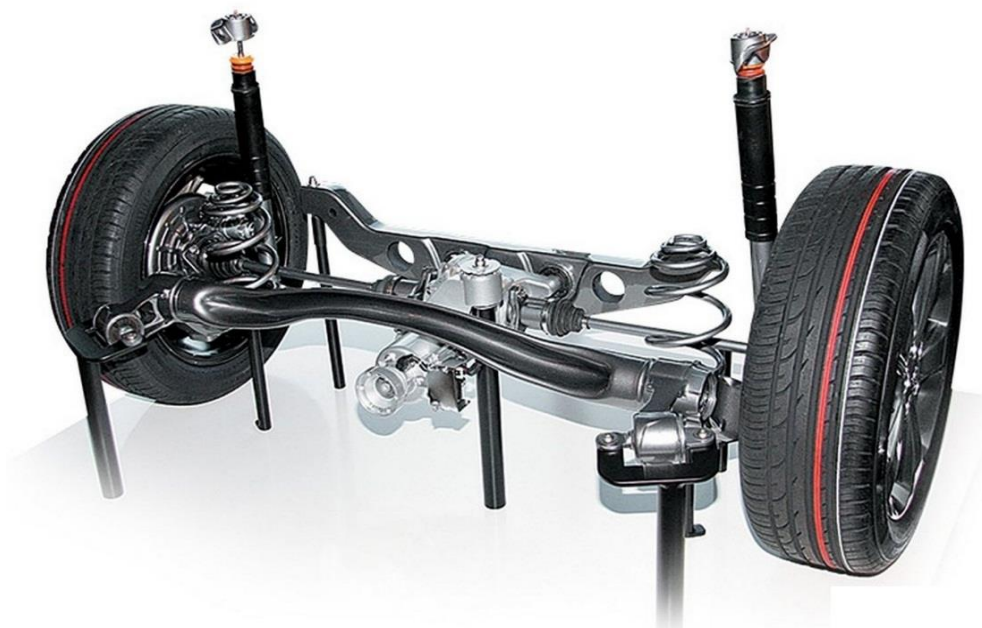
Рисунок 8 – Полузависимая задняя подвеска
