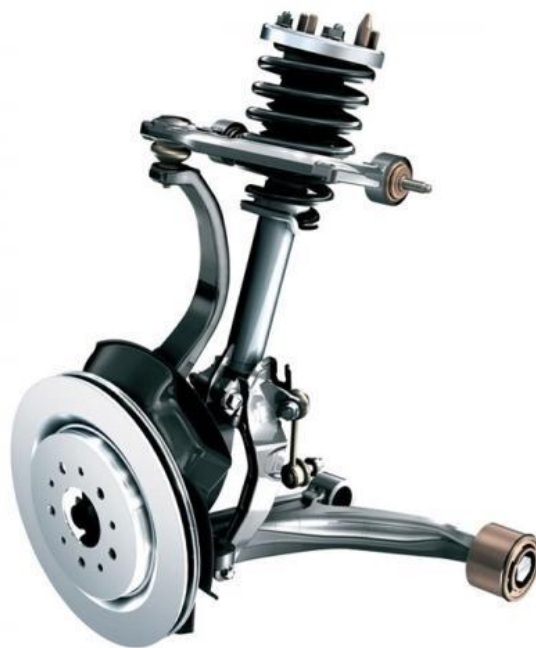
Рисунок 10 – Подвеска на двойных поперечных рычагах
