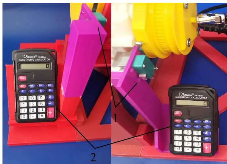
1 – концевые выключатели; 2 – считывающие устройства
