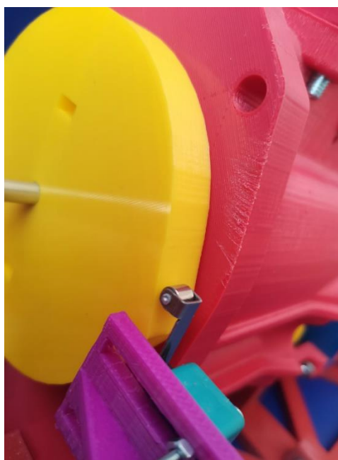
Рисунок 4.18 – Метка на выходном валу коробки передач при включении реверсивной передачи
