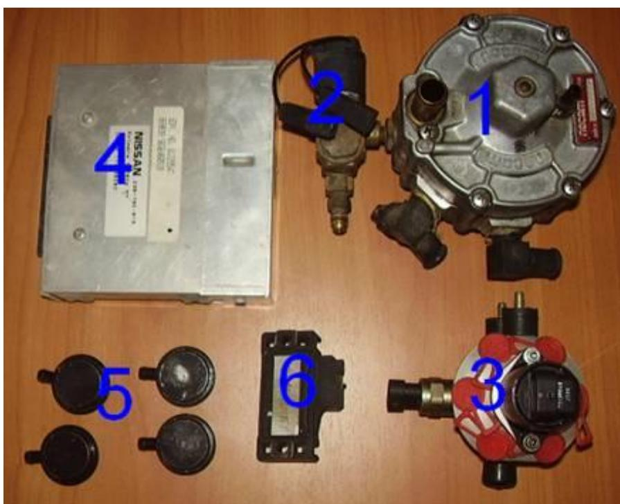
1 – двухступенчатый редуктор–испаритель; 2 – магистральный клапан с интегрированным фильтром жидкого газа; 3 – дозатор–распределитель; 4 – блок управления; 5 – обратные вакуумные клапана – «форсунки»; 6 – датчик абсолютного давления в коллекторе
