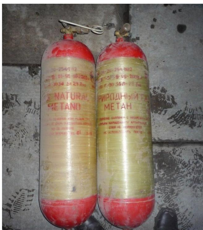
Рисунок 14 – Газовый баллон марки БА-51-20-254/1262 ТУ 4591-001-29416612-2005 с запорно-предохранительной арматурой
