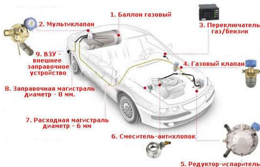
Рисунок 3 – Принципиальная схема ГБО второго поколения
