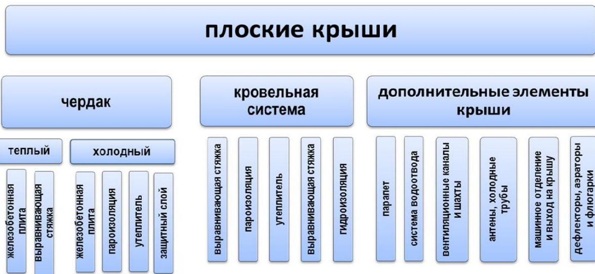
Рисунок 1.21 – Элементы плоских крыш
