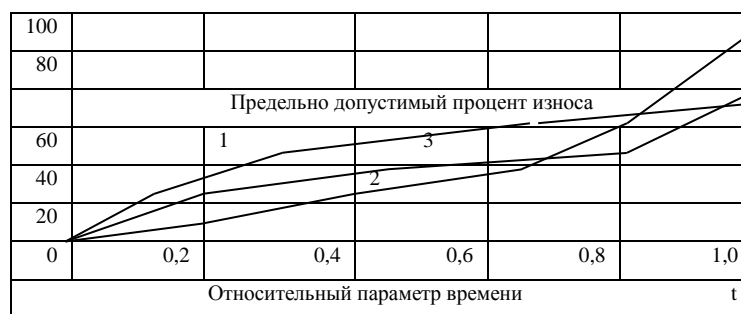
Рисунок 2.6 - Кривые износа жилых зданий в зависимости от продолжительности эксплуатации: 1 - выпуклая; 2 - вогнутая; 3 - кривая со смешанной формой
