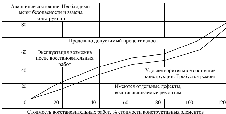
Рисунок 2.7 - Границы технического состояния конструкций
