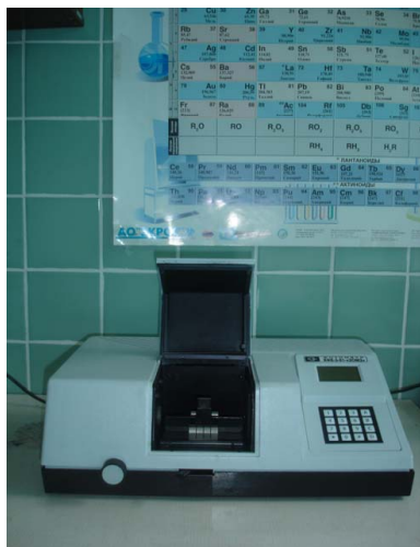
Рис. 7. Фотометр типа КФК-3-01
