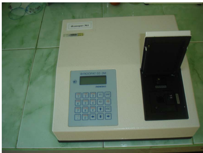
Рис. 10. Анализатор жидкости типа «Флюорат-02»
