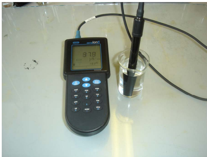
Рис. 11. Измеритель pH растворов
