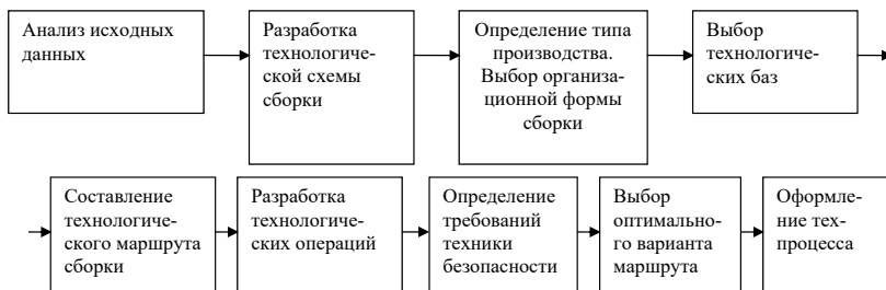
Рис. 1. Порядок проектирования технологических процессов сборки изделий
