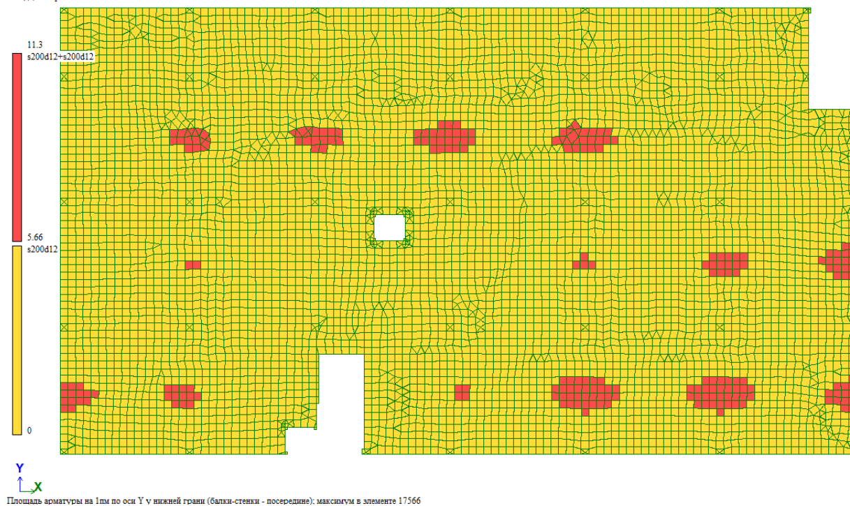
Рисунок Б.9 – Площадь армирования на 1 м.п. по оси Y у нижней грани
