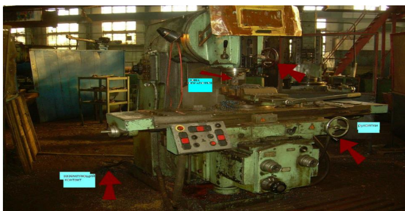
Рисунок 5 – Вертикальный консольно-фрезерный станок 6М12П с указанием опасных зон
