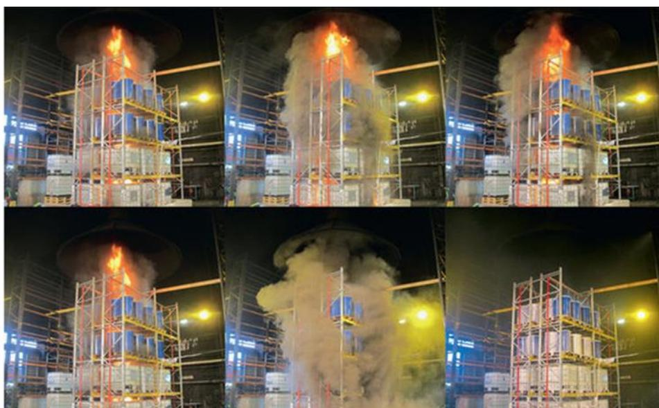
Рисунок 13 – Развитие пожара в испытании
