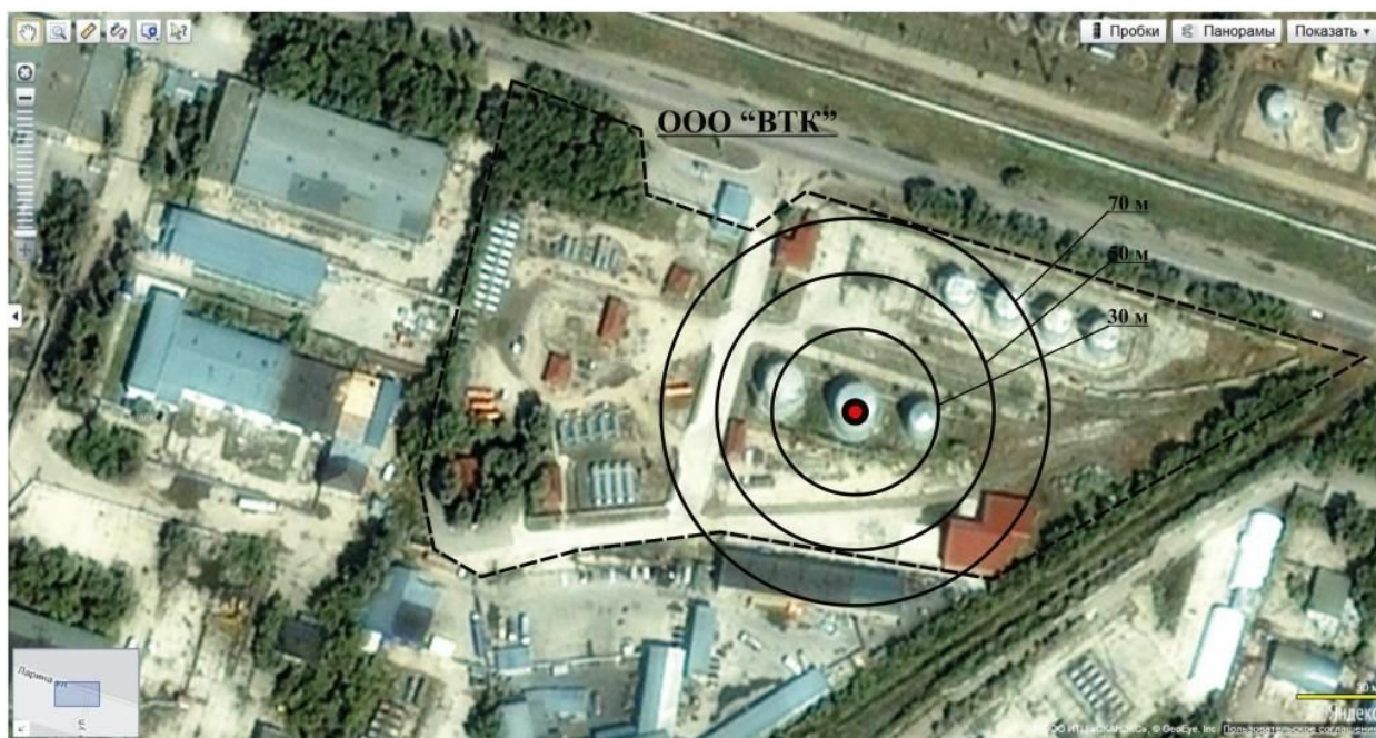
Рисунок 13 – Зоны теплового воздействия пожара пролива
