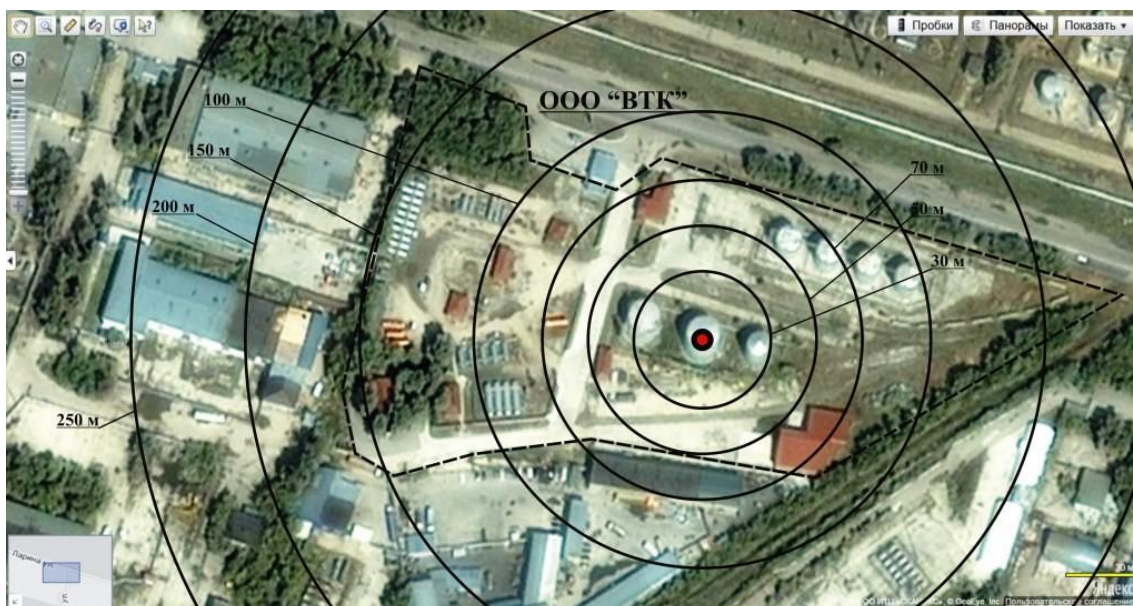
Рисунок 14 – Зоны избыточного давления взрыва
