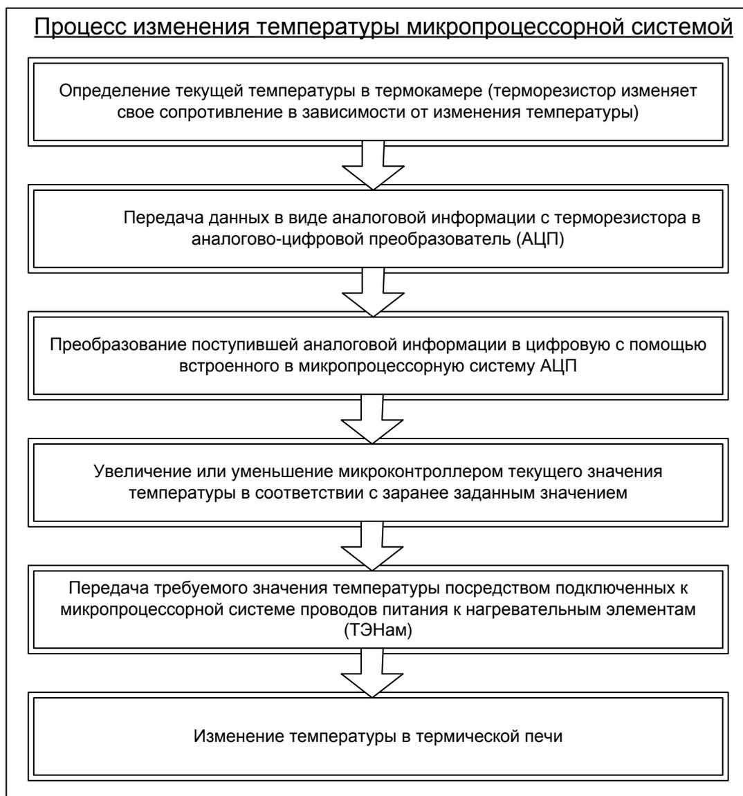
Рисунок 2.19 – Диаграмма последовательности действий в процессе изменения микропроцессорной системой температуры в термической камере.
