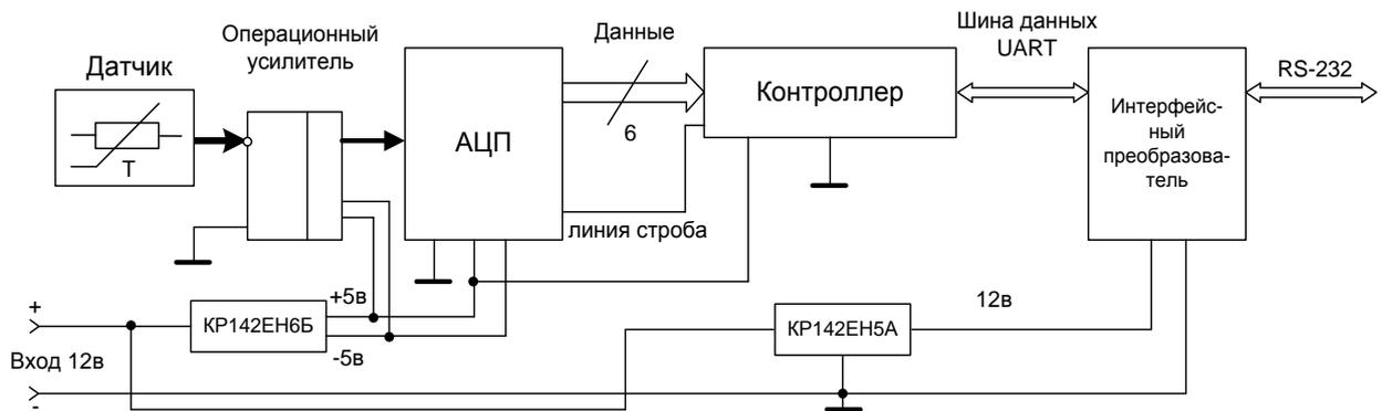
Рисунок 2.2 - Функциональная схема микропроцессорной системы регулирования температуры.
