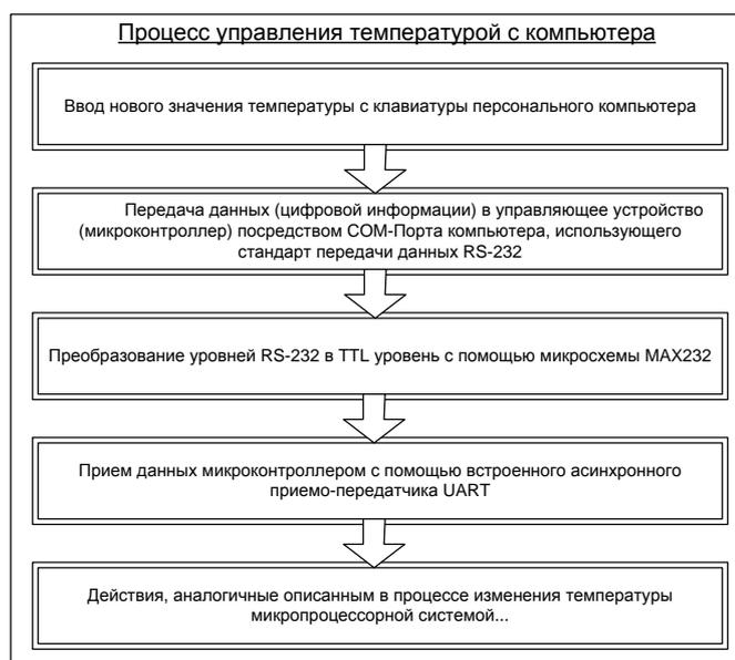
Рисунок 2.20 – Диаграмма последовательности действий в процессе изменения управления температурой с компьютера.
