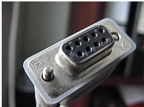
Рисунок 2.7 - 9-контактный разъем (DB-9) устройства, подключаемого к COM-порту, часто используемый для передачи по протоколу RS-232.
