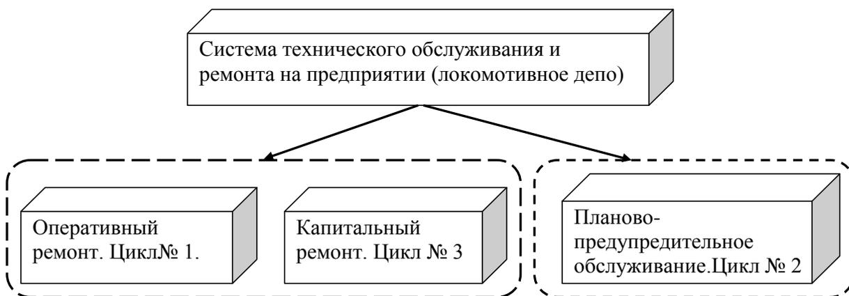
Рисунок 7 - Система распределения работ на категории "ремонт" и "обслуживание".
