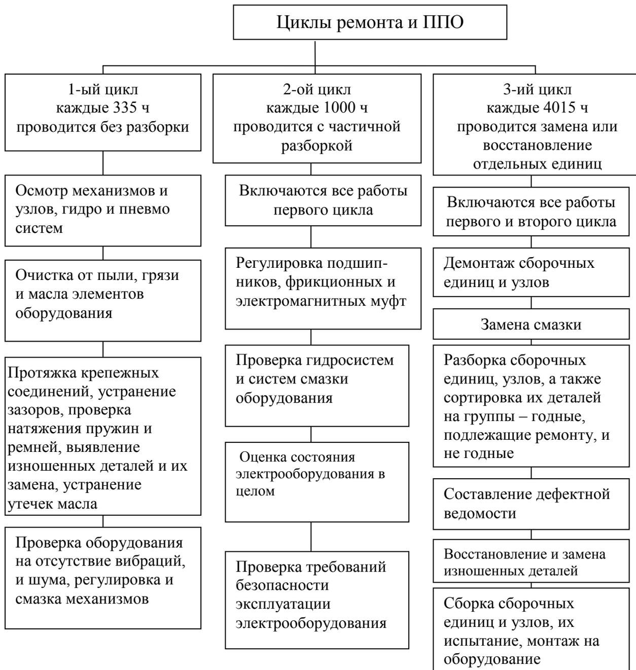
Рисунок 8 - Перечень работ по циклам ППО
