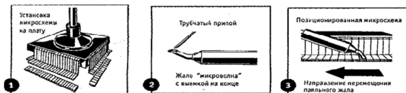
Рис. 2.9. Процедура пайки жалом «мини-волна» [34]
