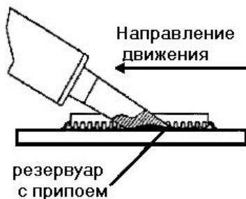
Рис. 2.8. Принцип пайки жалом «мини-волна» [33]
