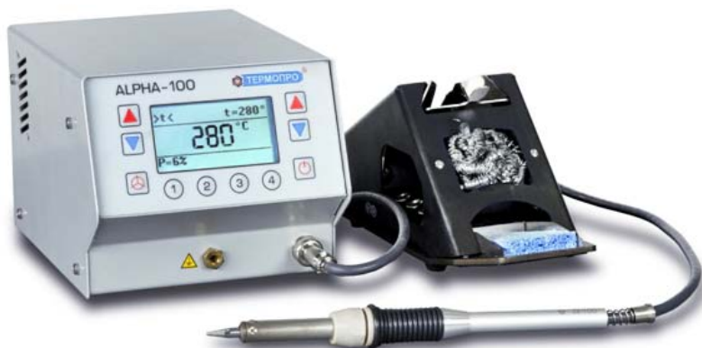
Рис. 2.52. Паяльная станция ALPHA-100 [26]
