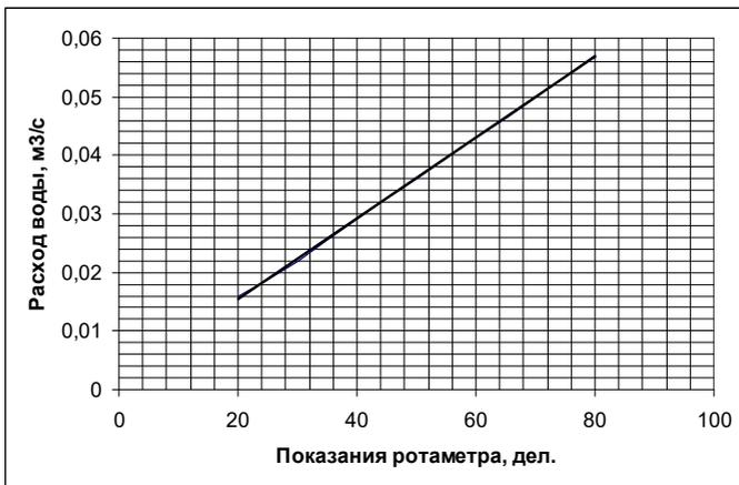
Рис. 7.3. Калибровочный график ротаметров 2 и 3
