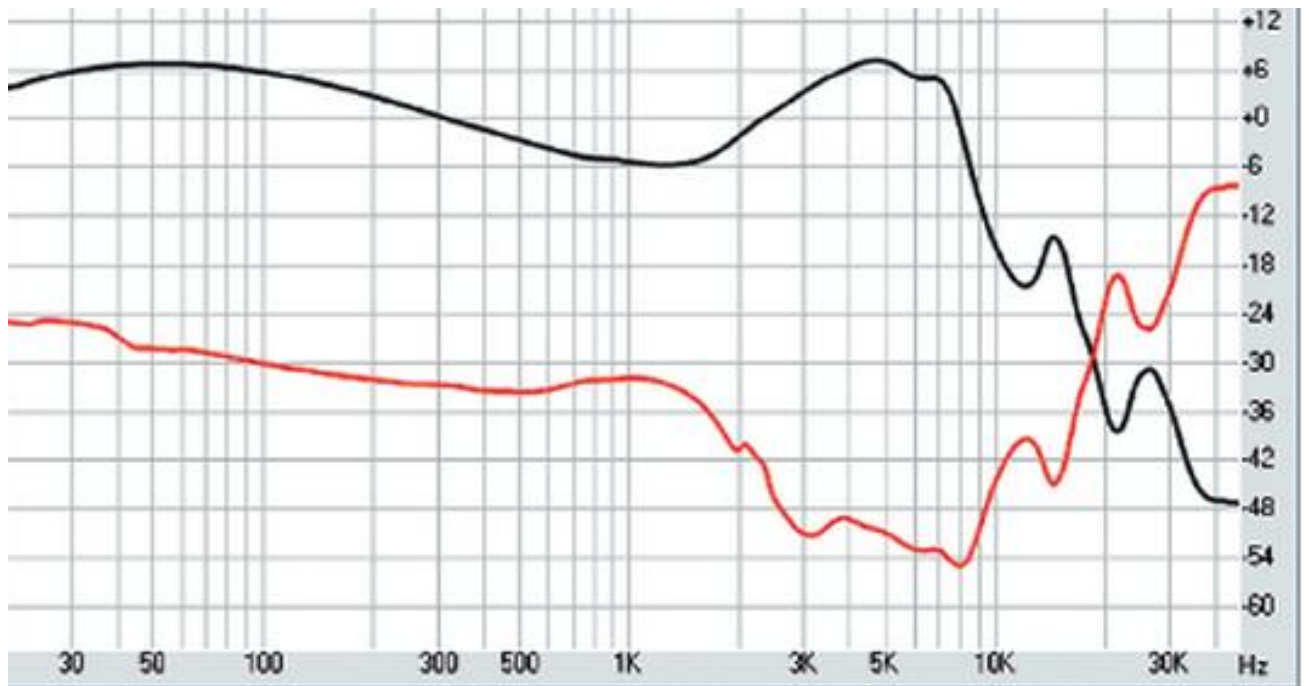
Рис. 1.4 АЧХ цифрового устройства для активного шумоподавления.
