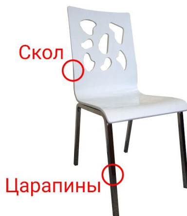
Рисунок 1 – Дефекты пластмассового стула
