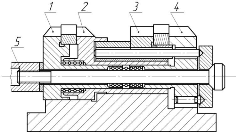
**Описание конструкции:** Данный зажим имеет четыре плавающие губки 1, 2, 3, 4 сквозь которые проходит винт. Между губками имеются пружины для быстрого отвода губок при разжиме. 3-я и 4-я губки двигаются по дополнительной направляющей оправке.
