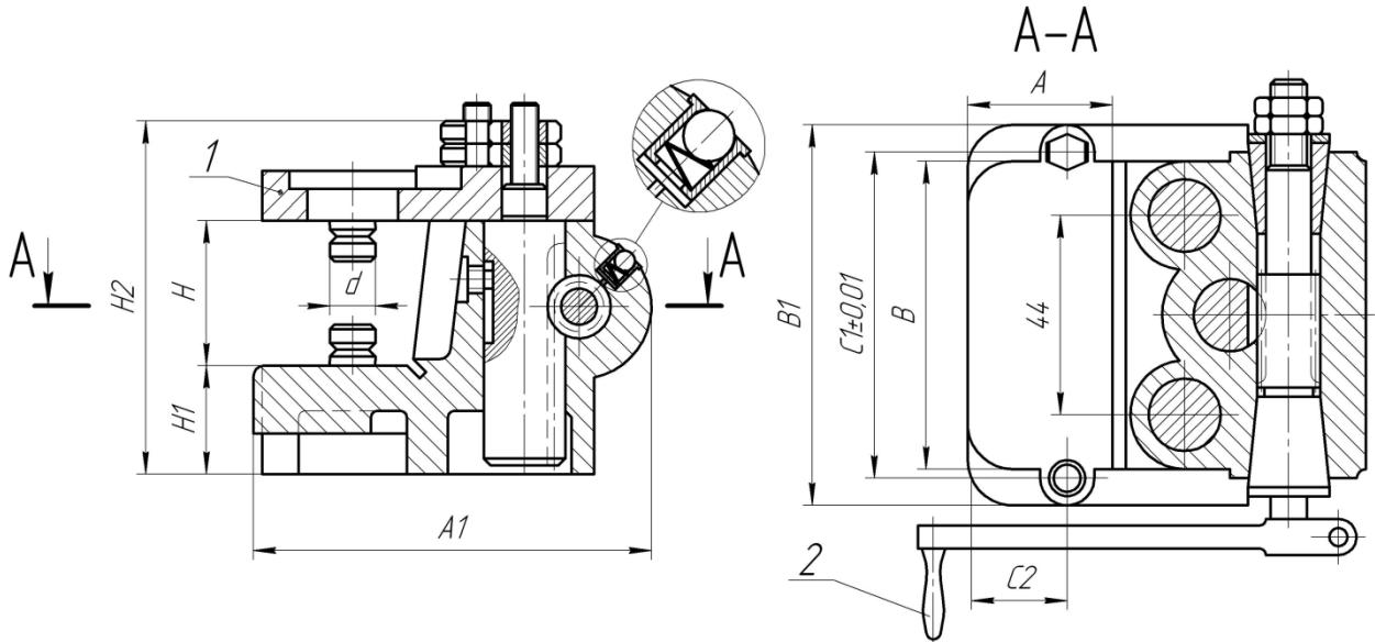
**Назначение:** Предназначен для сверления отверстий в различных заготовках.
