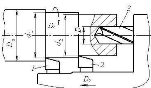
При обработке заготовки из конструкционной стали, вращающейся с частотой  $n$ , проходные резцы 1 и 2 и сверло 3 объединены в многоинструментальную наладку (см. рис.), параметры которой приведены в табл. I, II и III.
