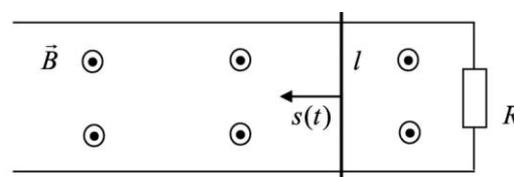
закону  $s(t) = at^3$ . Расстояние между направляющими  $l = 10$  см. Найти зависимость от времени силы тока  $I(t)$ , протекающего через резистор. Построить график зависимости  $I(t)$  в интервале времени от 0 до  $t$ .
