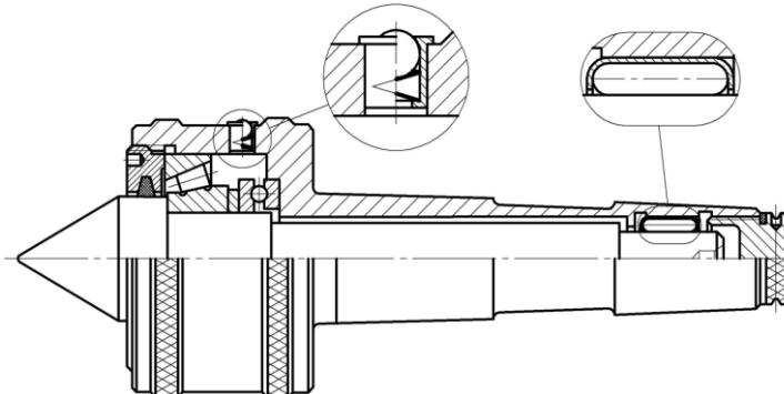
**Назначение:** Применяют при обработке деталей типа вал. Воспринимает осевые и радиальные нагрузки.
