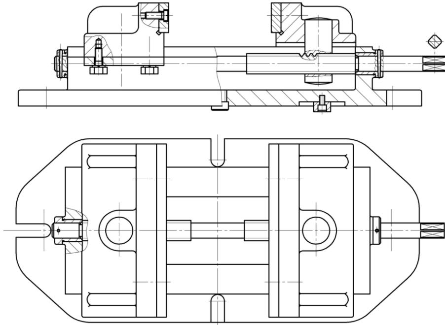
**Назначение:** Применяют в качестве универсальной оснастки в случае необходимости точного базирования плоскости симметрии зажимаемой заготовки.
