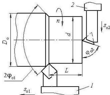
При обработке заготовки на станке с ЧПУ на продольном суппорте 1 установлен проходной токарный резец, работающий с подачей  $s_{01}$ , а на поперечном суппорте 2 – подрезной резец со сменной пластиной, имеющей  $i_{tp}$  граней (см. рис.). В плане пластина имеет вид правильного многоугольника.
