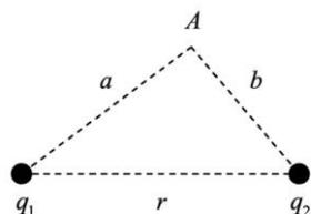
**Задача 1.** Два точечных заряда  $q_1$  и  $q_2$  находятся в вакууме на расстоянии  $r$  друг от друга. Найти модуль напряженности электрического поля, создаваемого этими зарядами, в точке  $A$ , находящейся на расстоянии  $a$  от первого заряда и на расстоянии  $b$  от второго заряда.
