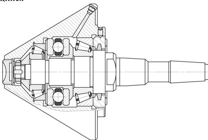
**Назначение:** Применяют при обработке полых цилиндров и труб. Воспринимает осевые и радиальные нагрузки.
