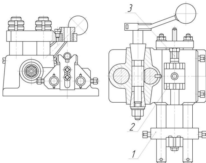
**Принцип работы:** Закрепление заготовки осуществляется опусканием кондукторной плиты, затем сверло направляют в кондукторную втулку для просверливания отверстия в точно намеченном месте.
