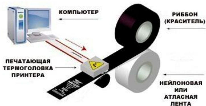
Рисунок 3.6 – Устройство термотрансферной печати
