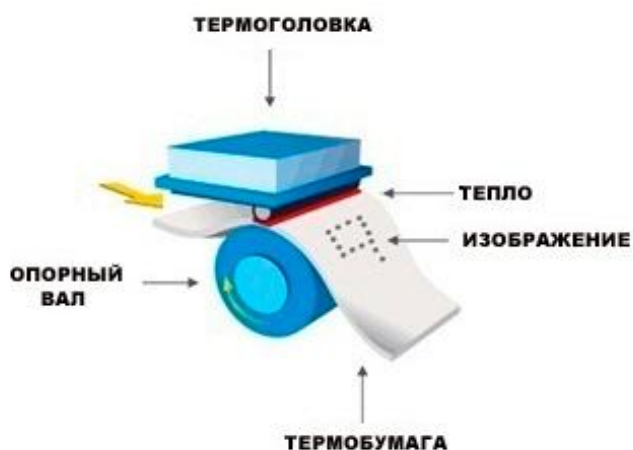
Рисунок 3.5 – Устройство термопечати
