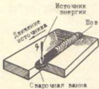
Рис. 2. Схема сварки плавлением
