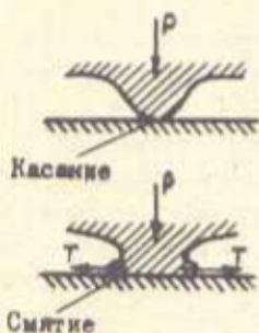
Рис. 19. Смятие выступа и течение металла
