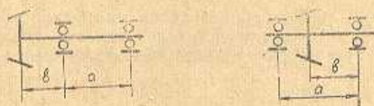
Рис. 3. Схемы установки ведущих валов главной передачи.
