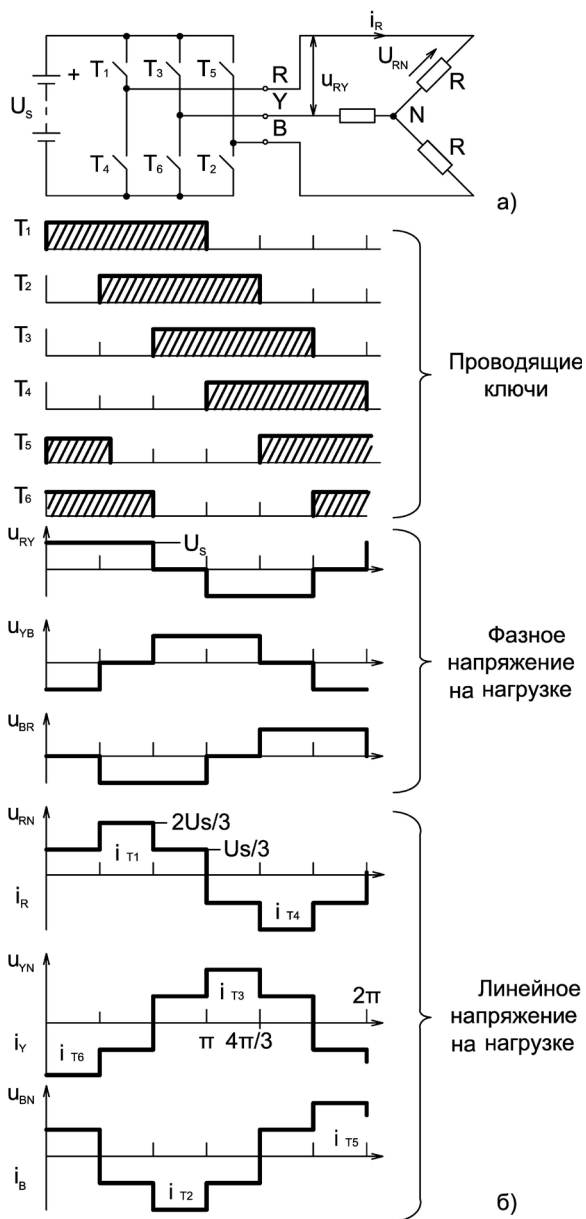
Рис. 4.2. Трехфазный мостовой инвертор, в котором каждый тиристор проводит ток в течение 180 эл. град: а – проводящие ключи; б – диаграммы управления фазных и линейных напряжений на нагрузке
