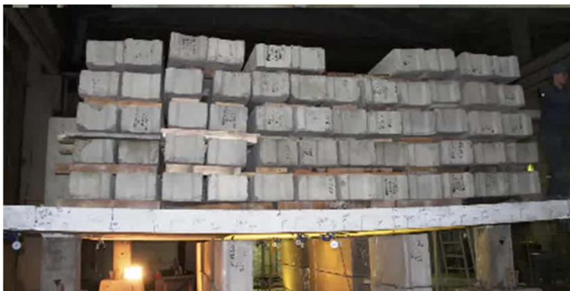
Рис. Б3. Натурные испытания фрагмента сборно-монолитного каркаса здания сотрудниками центра технических инноваций и модернизаций в строительстве «МИКС»: *а* – подготовка к испытаниям; *б* – нагружение безбалочного диска перекрытия штучными грузами (нагрузка составила  $10 \text{ кН/м}^2$ )
