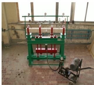
Рис. 13. Установка для испытаний балочных конструкций на знакопеременные нагрузки: 1 – образец балки; 2 – реверсное устройство; 3 – опорные стойки; 4 – домкрат ДГ10; 5 – динамометр ДОС-3
