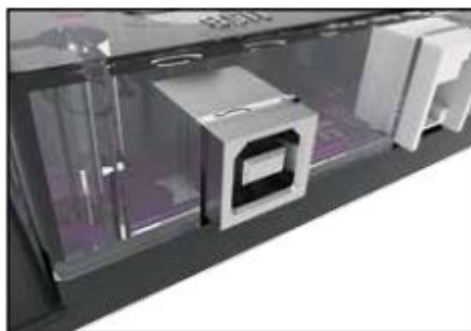
Рисунок 11 – Порт USB на контроллере PRIZM, предназначенный для программирования и связи
