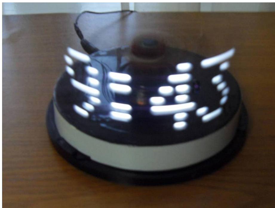
Рис. 1.1. – Вращающиеся светодиодные часы.
