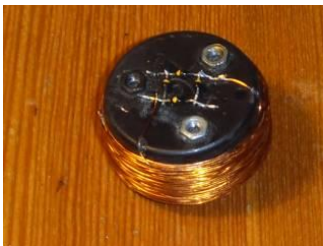
Рис. 3.5 – Вторичная обмотка воздушного трансформатора, намотанная на месте отломанных лопастей вентилятора.
