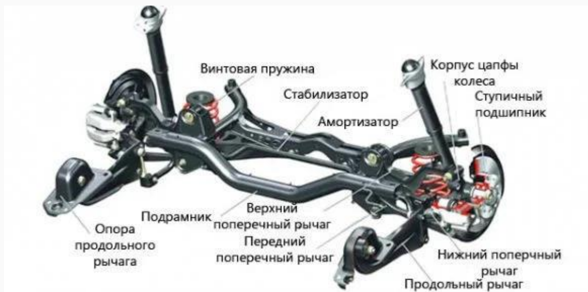
Рисунок 1.7 – Многорычажная подвеска
