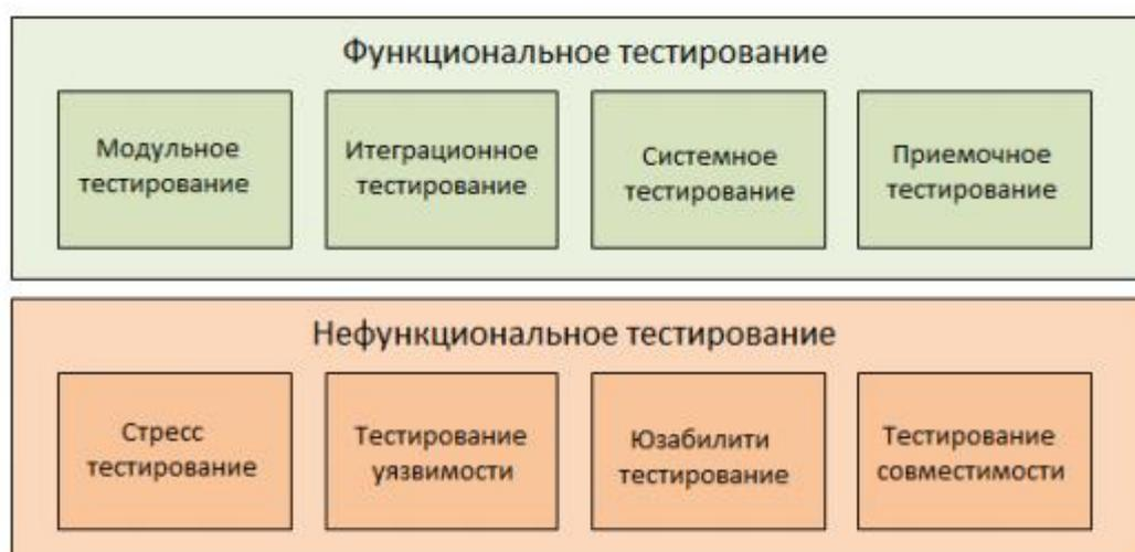
Рисунок 4.1 - Общая схема основных видов тестирования
