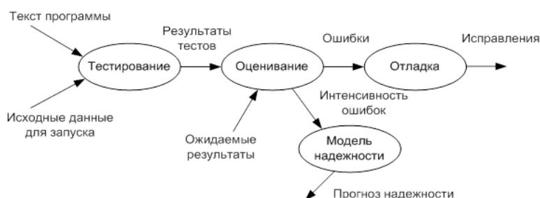
Рисунок 4.2 – Общий алгоритм тестирования
