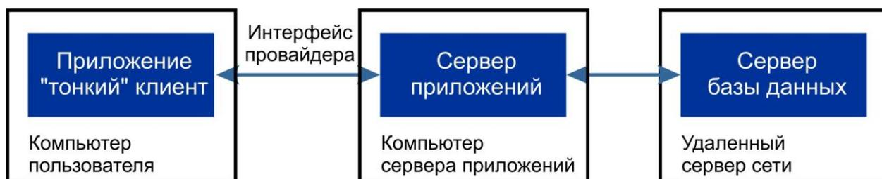
Рисунок 2.9 – Трехуровневая архитектура клиент-сервер
