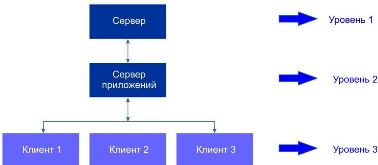
Рисунок 2.8 – Многоуровневая архитектура клиент-сервер
