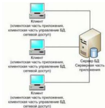
Рисунок 1.2 – Двухуровневая архитектура «клиент-сервер»
