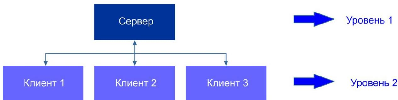
Рисунок 2.7 – Двухуровневая архитектура клиент-сервер
