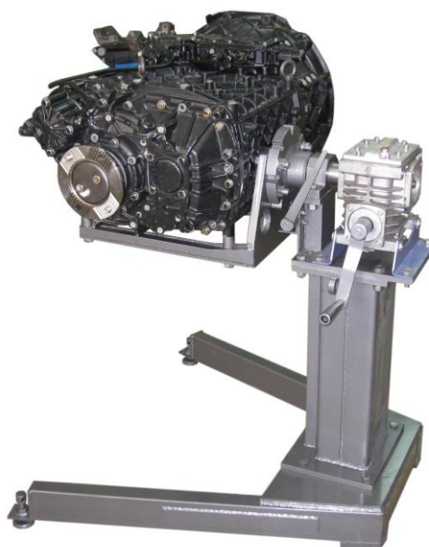
Рисунок 2 – Стенд для проведения ремонтных работ по коробкам передач и другим агрегатам грузовых автомобилей ЛПН-078.00.000
