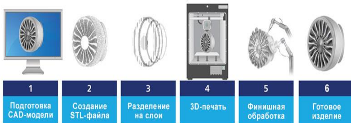
Рисунок 7 - Общая схема аддитивного производства, предлагаемая для АО «УММ»
