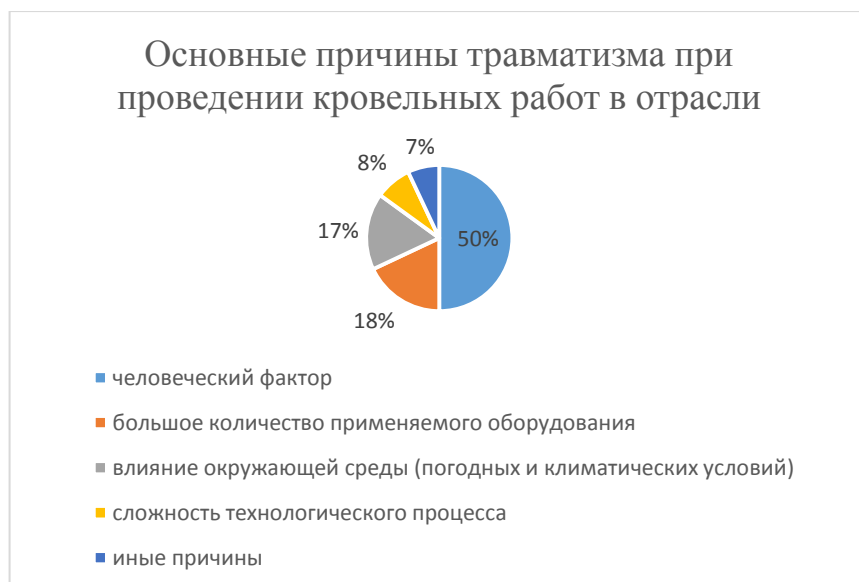
Рисунок В.8 – Основные причины травматизма при проведении кровельных работ
