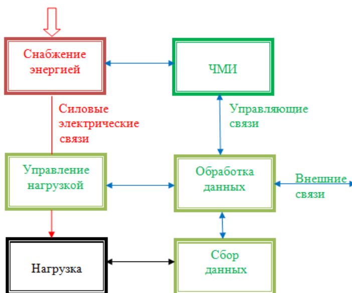
Рисунок 6 – Схема связи оборудования автоматизации
