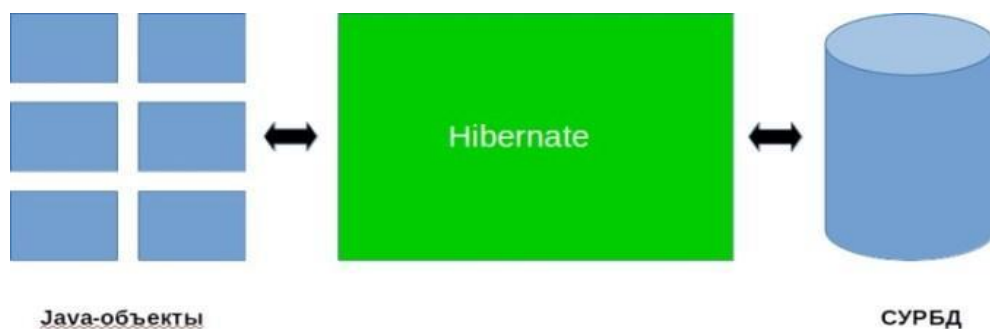
Рисунок 15 - Схема взаимодействия Hibernate с другими частями веб-приложения
