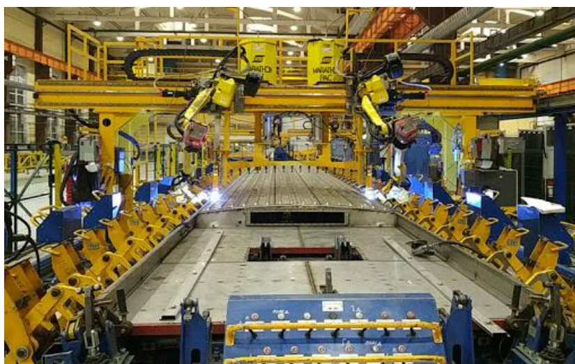
Рисунок 2.9 – Роботизированная сварка корпусов вагонов
