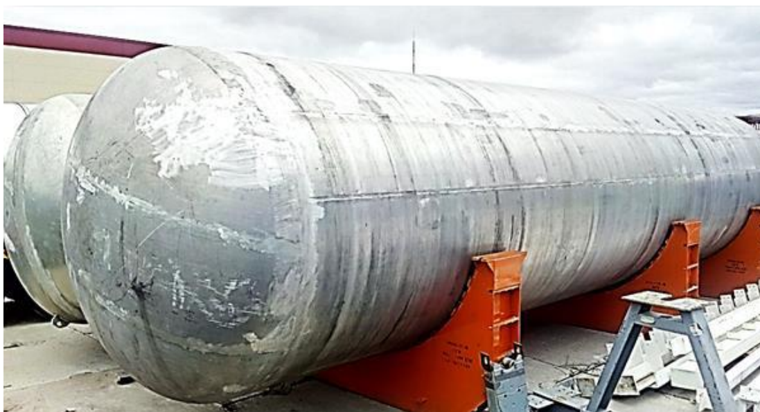
Рисунок 1.10 – Алюминиевые котлы вагона-цистерны, выполненные с применением ротационной сварки трением
